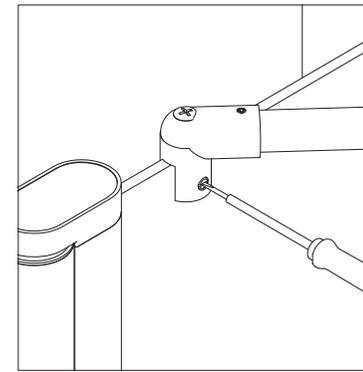
**Paso 12:** Realizar el mismo procedimiento en el extremo opuesto. Colocar la pinza vidrio y fijarla con el tornillo interior.
