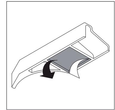
**Paso 13:** Retirar el papel adhesivo de la pieza embellecedora del perfil base, y colocar la pieza en su posición.
