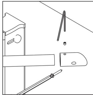
**Paso 11:** Para los modelos que lleven barra de refuerzo, atornillar en la pared el soporte de 45°. Luego insertar la barra y fijar con el prisionero.
