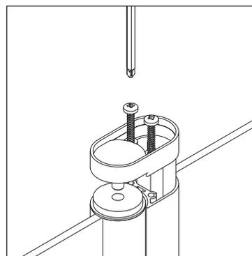
**Paso 6:** En los modelos que lleve perfil bisagra, se tendrá que desatornillar la pieza superior. El siguiente paso es alojar la hoja en la pieza inferior del perfil bisagra. Por último volver a colocar la pieza superior.
