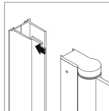
**Paso 3:** Insertar el conjunto hoja en el perfil expansor, que previamente se a atornillado a la pared con los tornillos de 4,8x32.
