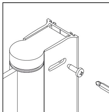
**Paso 5:** Una vez insertado el conjunto hoja o fijo en el perfil expansor. Atornillar por la parte de dentro con el tornillo 4,8x16. Este tornillo será el que nos permita regular el descuadre que pueda tener la pared con el perfil.
