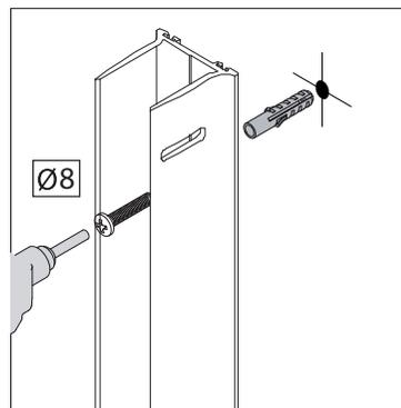
**Paso 2:** Usar una broca especial para taladrar en superficies de cerámicas. Insertar los tacos de 8m/m y atornillar el expansor con los tornillos de 4,8x32 que vienen con los accesorios de la mampara.
