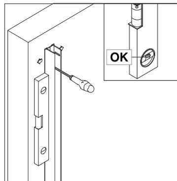
**Paso 1:** Antes de dar el primer paso se debe comprobar que se encuentra a nivel el plato de ducha. Luego nivelar el perfil expansor, marcar con un lápiz la posición de los taladros.
