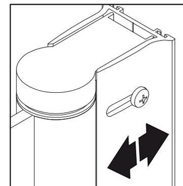
**Paso 8:** Regular con el tornillo del expansor la posición deseada. Y colocar el tapón embellecedor del tornillo
