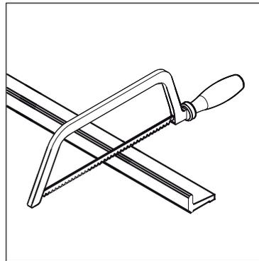
**Paso 15:** Si fuese necesario cortar el sobrante con una sierra para aluminio. Retirar el papel adhesivo del perfil base y colocar en su posición.
