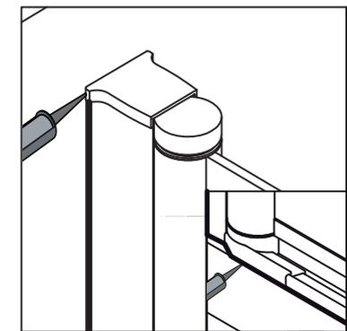
**Paso 18:** Por último aplicar silicona especial baño en todo el perímetro exterior de la mampara, como indica en la figura de arriba.
